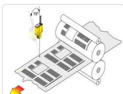
**Fotocelda:** (permite tener centrada la impresión en la bolsa).
